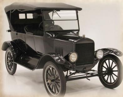
La *Ford Model T* fut la première voiture construite sur une chaîne de montage mobile. C'est ainsi que la durée de fabrication d'une automobile passe de 12 heures à 2 heures.
